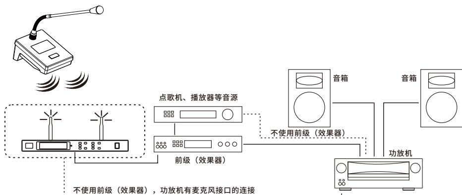
1. 接收机装好天线，按上图连接好设备，先不要打开音响设备电源；
