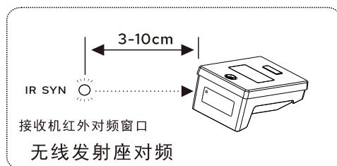
2. 发射座对频窗靠近对准接收机对频灯，完成对频
